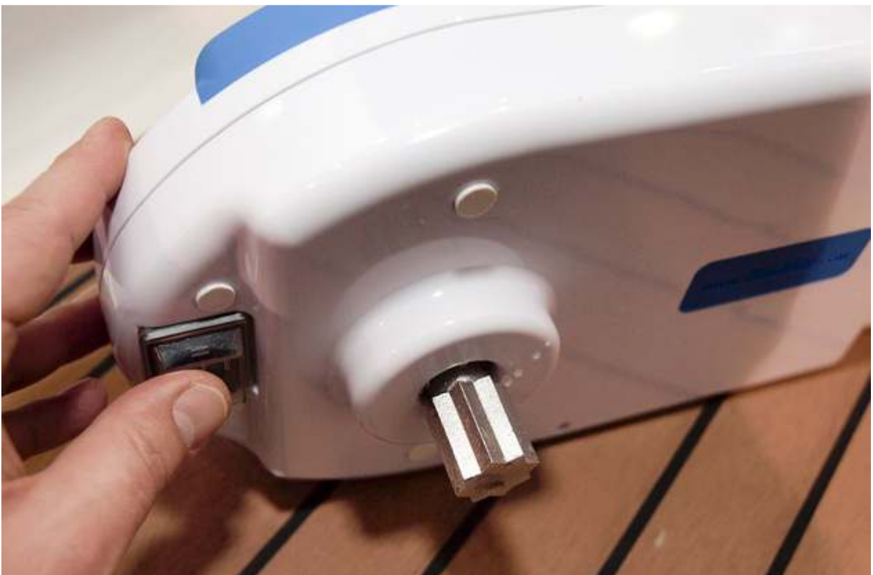
Um auch Zweigangwischen nutzen zu können lässt sich die Drehrichtung umschalten
